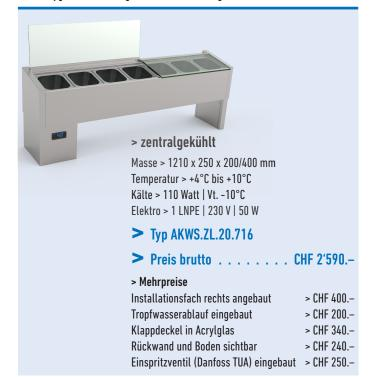
Aufsatzkühlwanne, zentral- oder eigengekühlt für die Aufnahme von GN 1/6 Schalen, Höhe maximal 150 mm. Stille Kühlung mit effizienter Kontaktberohrung. Das Installations-/Aggregatfach ist links angebaut. Alle Kühlgeräte nach DIN 18872-1 und in Hygieneausführung DIN 18865-9 H2 hergestellt.
