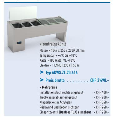
Aufsatzkühlwanne, zentral- oder eigengekühlt für die Aufnahme von GN 1/6 Schalen, Höhe maximal 150 mm. Stille Kühlung mit effizienter Kontaktberohrung. Das Installations-/Aggregatfach ist links angebaut. Alle Kühlgeräte nach DIN 18872-1 und in Hygieneausführung DIN 18865-9 H2 hergestellt.
